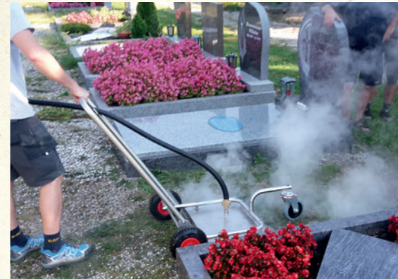
Heißdampfgerät zur Unkrautbekämpfung auf dem Friedhof Mank.
