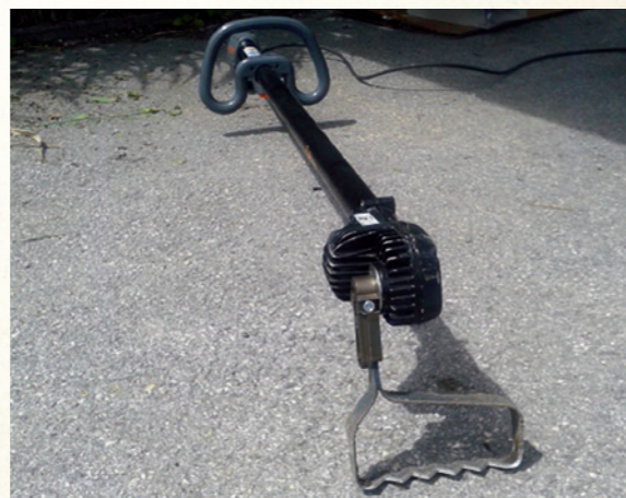
Elektrische Pendelhacke der Fa. Hochfilzer.
